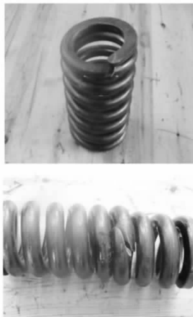
图 1 弹簧断裂部位
